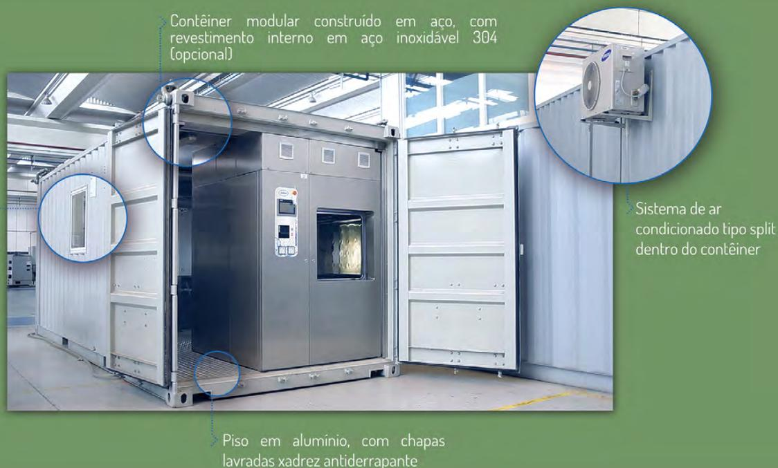
No interior do contêiner estão os equipamentos e acessórios para o tratamento de resíduos sólidos infectantes: autoclave, racks de carga e descarga e triturador para a descaracterização dos resíduos.
